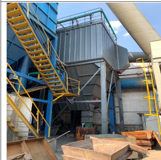
6#熔炼炉除尘系统
