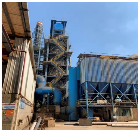
回转精炼炉布袋除尘及水喷淋系统
