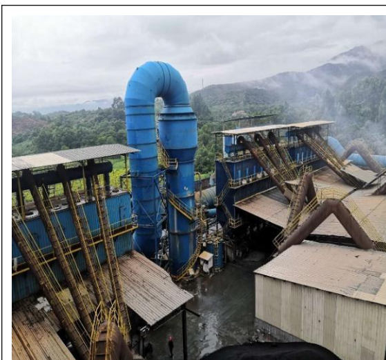
熔炼炉除尘系统
